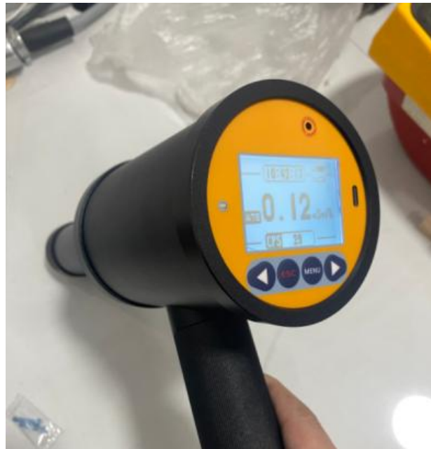
图 3-12 便携式辐射剂量监测仪
